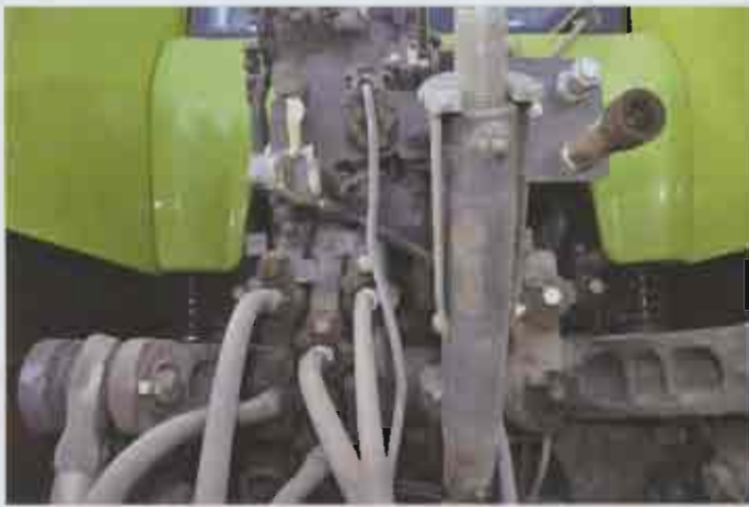
Задня гідравлічна система трактора Axion Claas
